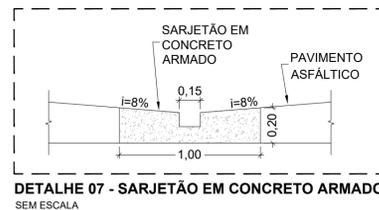
**DETALHE 07 - SARJETÃO EM CONCRETO ARMADO**
